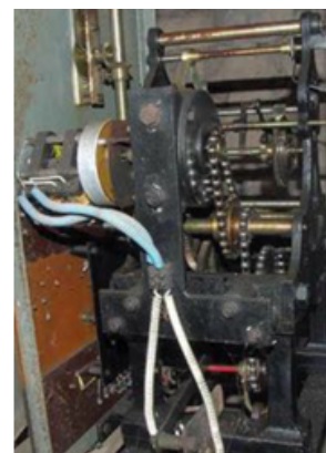
Système de déclenchement des cloches datant de 1959
